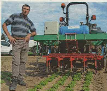
Pascal Pinguette utilise une bineuse à guidage automatique, qui passe entre les salades.
