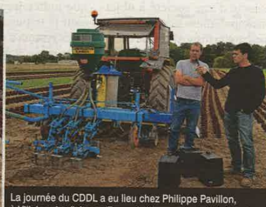
La journée du CDDL a eu lieu chez Philippe Pavillon, à Villebernier (ici avec François Cornuault, de l'Union des Cuma). Le maraîcher utilise une bineuse traditionnelle Super-Crop équipée de lames sur-mesure pour ses plants de salades.
